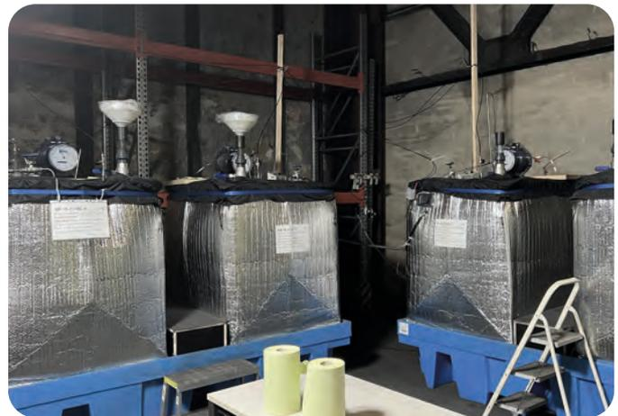
Messung von Treibhausgasemissionen von unbehandelter Gülle und mit Eminex® behandelter Gülle im 1.000 Liter Maßstab.
